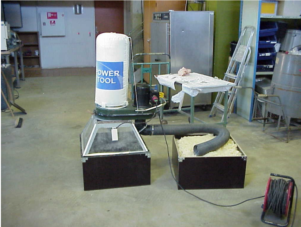
Foto nr. 3.5.2. Apparat til indblæsning af løsfyldsisolering i målekasse
