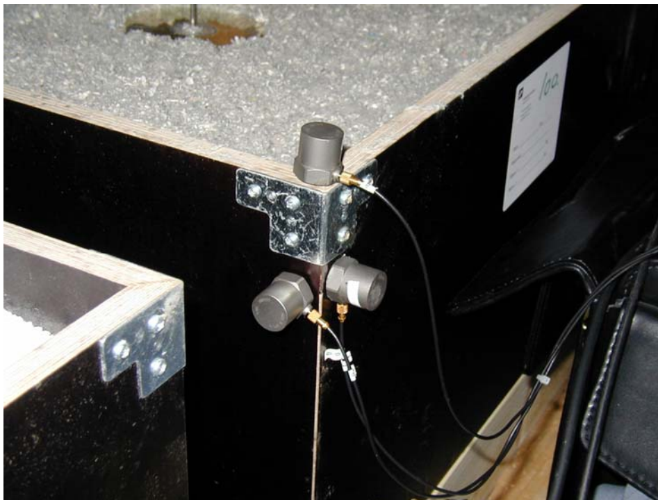
Foto 3.7.3. Vibrationsmåling på kasse nr. 100, Bøgeskovparken 131, ikke-vibrationsisoleret kasse med Ekofiber.
