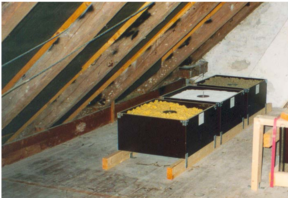
Foto 3.4.1. Gruppe af målekasser opstillet i Højbjergparken 1. Kasserne er fastgjort til langsgående planker, der er fastgjort til gulv i loftrum. Kasserne er fremstillet af 15 mm støbekrydsfiner.
