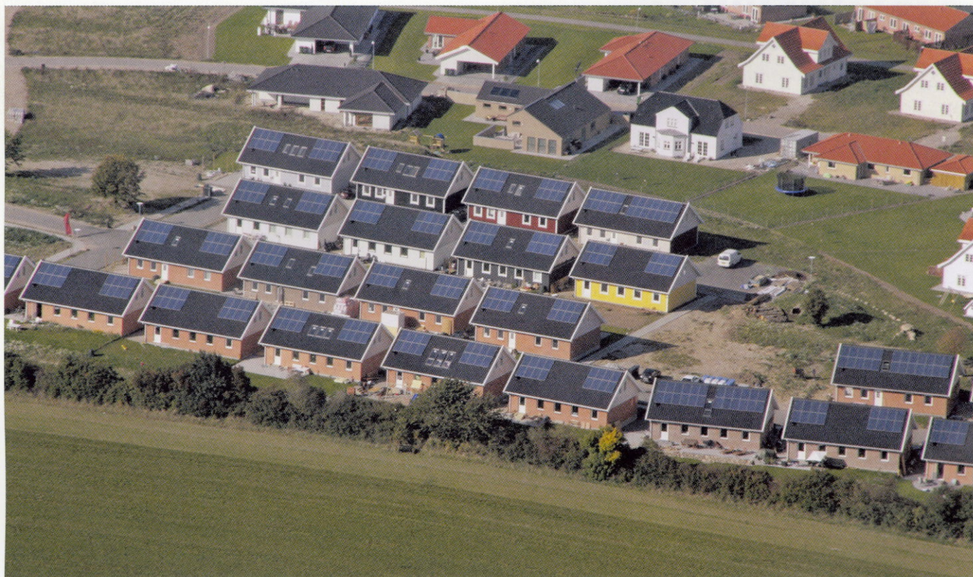
Det internationale energiagentur (IEA) har beregnet, at Danmark har egnede tage og facader nok til at dække 30 % af vores elforbrug fra bygningsintegrerede solcelleanlæg. Her ses Byggeföreningen Kyoto. Copyright: Gaia Solar.
