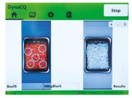
DynaCQ markiert Verunreinigungen mit einem Halo, hier in einem Tablett, das mit Fragmenten aus weichem und hartem Kunststoff sowie mit
