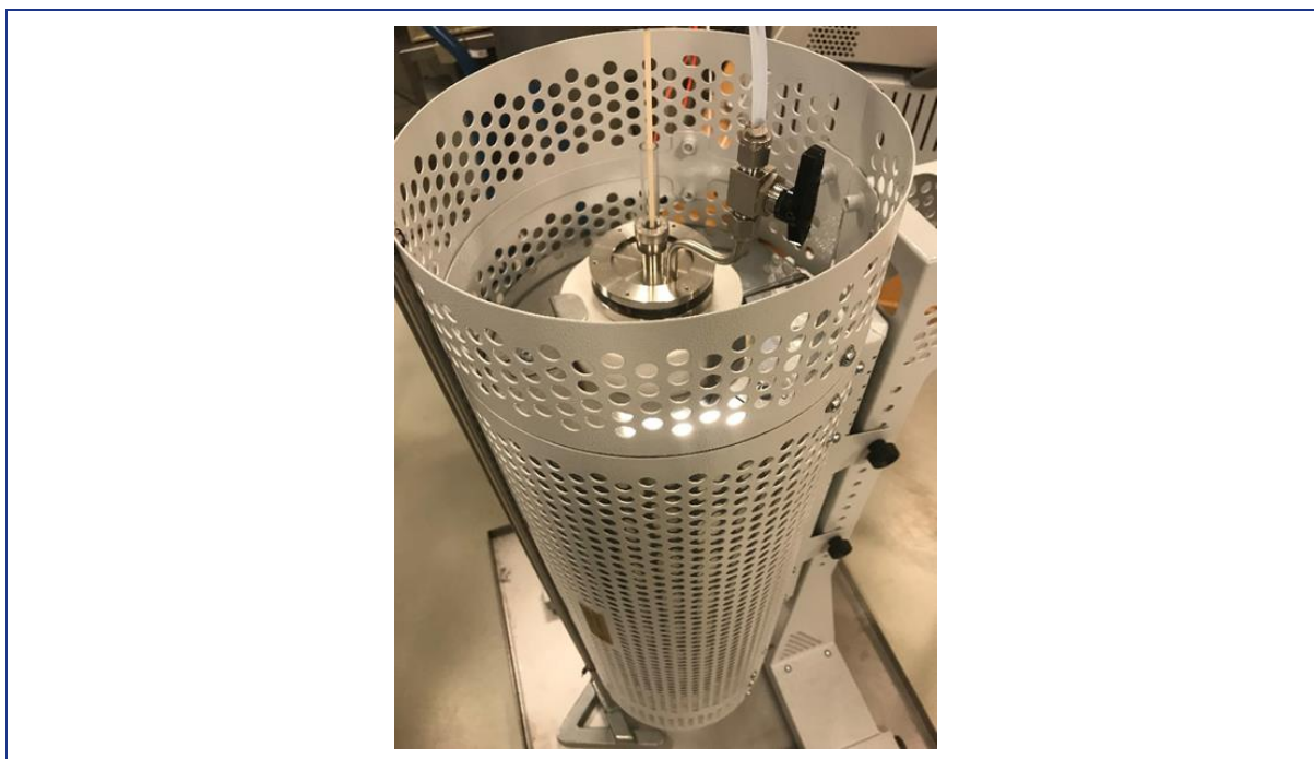
Figur 8.1: Foto af testovn med smeltecellen. I midten ses et kvartsrør med termoføler og tilslutning til argon-beskyttelsesgas. Selve smeltecellen med det faseskiftende materiale (AlSi12) er ikke synlig, men vist i Figur 8.3.
